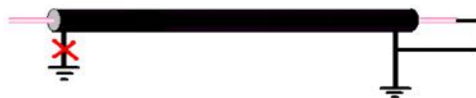
欲识别电缆测试前连线处理
